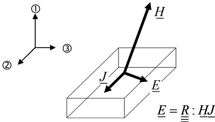
Para la situación representada en la figura (en la que los ejes son los convencionales del material del que está hecho el sensor, las caras de la barra son perpendiculares a los ejes, y la corriente circula en la dirección del eje 2), y supuestas conocidas todas las componentes  $R_{ijk}$  del coef. de efecto Hall, la componente 2 del campo eléctrico está dada por:
