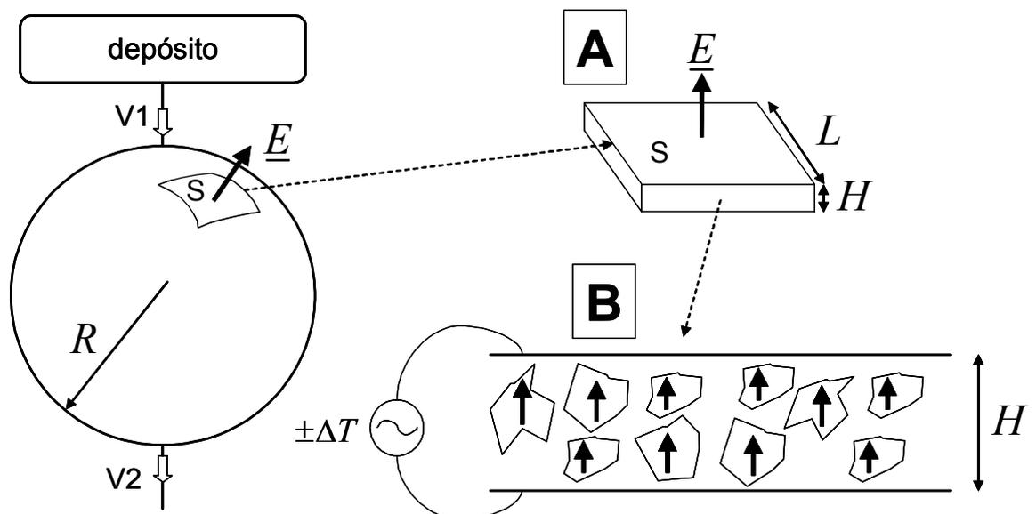
**Sol.:** el material tiene un eje de orden infinito en la dirección de polarización de las partículas piezoeléctricas, por ser invariante respecto a cualquier rotación en torno a este eje. El eje de orden infinito debe ser el eje convencional 3. En cada punto de la membrana este eje apunta en dirección radial, igual que el campo eléctrico aplicado:
