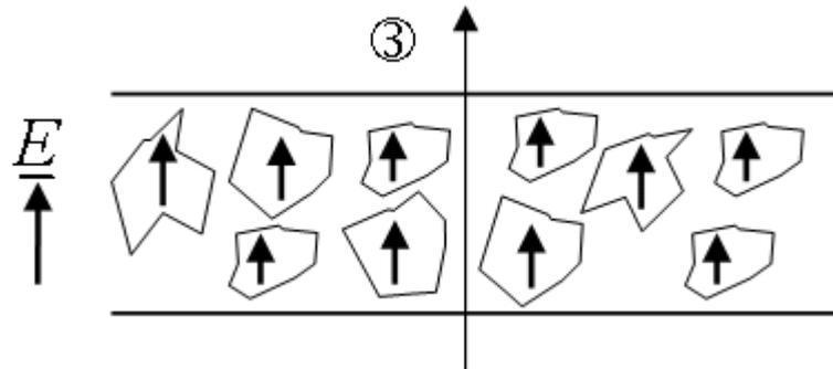
Los otros dos ejes se pueden elegir arbitrariamente siempre que sean perpendiculares al 3 y perpendiculares entre sí. Las direcciones 1 y 2 son equivalentes en todas las propiedades, y el material es transversalmente isótropo.
