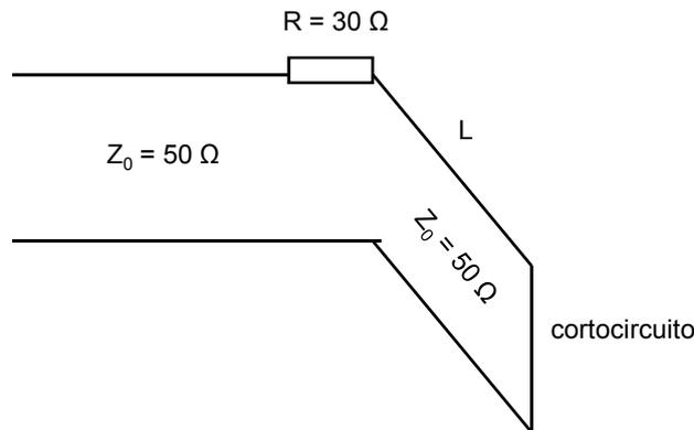
Cuando la línea de transmisión principal se alimenta con un generador, se obtiene una onda estacionaria en esta línea principal de valor de relación de onda estacionaria igual a 3 y siendo la tensión en un máximo igual a 15 V. Además se observa que la distancia entre el primer máximo y el primer mínimo más cercanos a la carga  $R$  es de 0,25 metros, estando el máximo de tensión más cercano a la carga  $R$  que el mínimo
