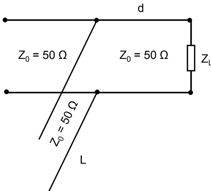
1.- Si  $d=45^\circ$ , indique en la carta de Smith el conjunto de impedancias que se podrían adaptar variando la longitud eléctrica del sintonizador.
