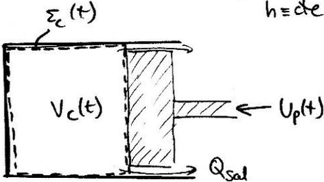
Para calcular  $P_0$  (o equivalentemente  $P_e$ ) aplicamos continuidad en forma integral al fluido que queda a la izquierda del pistón
