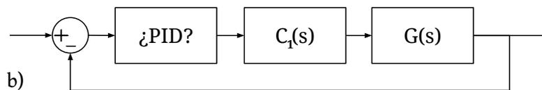
Se quiere reemplazar el controlador proporcional para reducir el tiempo de pico y el tiempo de respuesta a  $2/3$  de los actuales sin alterar la sobreoscilación. Además se quiere anular el error ante entrada escalón y acotar el error ante rampa a 3,84. Con este fin, se calcula un primer controlador  $C_1(s) = \frac{1}{s+10}$  y se deja la tarea de completar el diseño del sistema de control en su mano.
