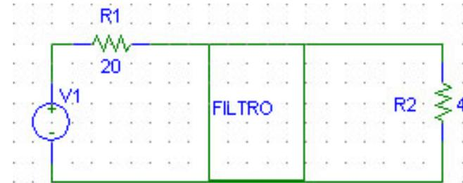
Se pide diseñar un filtro Butterworth a disponer entre una fuente de voltaje y una carga de  $4\Omega$ .
