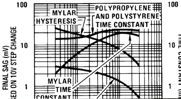
En la figura se muestra el error en mV (SAG) y la cte. de tiempo en ms, de diferentes dieléctricos, cuando se utilizan como capacidad de retención en un S/H. La menor absorción dieléctrica se consigue en dieléctricos del tipo: Teflón, poliestireno, polipropileno y algunos cerámicos del tipo COG y NPO.
