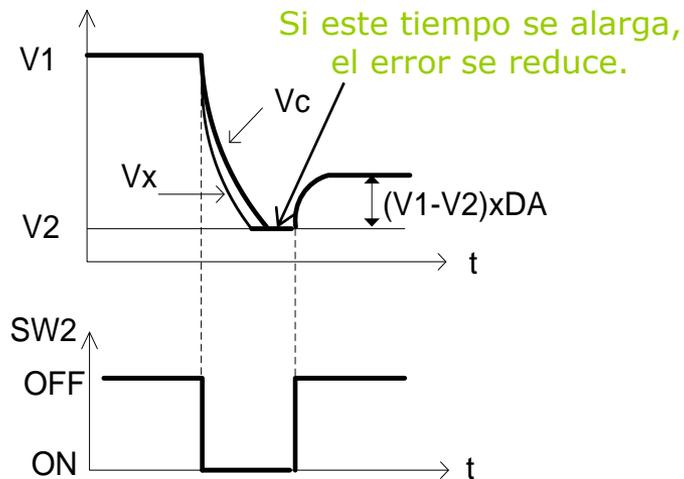
La absorción dieléctrica produce un error en la toma de la tensión  $V_2$ , que es función de la diferencia de tensión entre  $V_2$  y la tensión del canal anterior,  $V_1$ .
