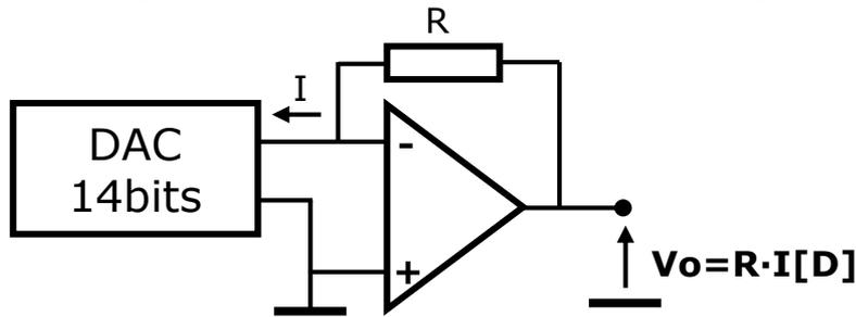
Una resistencia estándar de película metálica presenta un CT de  $\pm 100\text{ppm}/^\circ\text{C}$ , si  $\Delta t = 10^\circ\text{C}$ , la incertidumbre de ganancia es:  $\pm 1000\text{ppm} \rightarrow \pm 16.4q$ . **iMuy elevada!**
