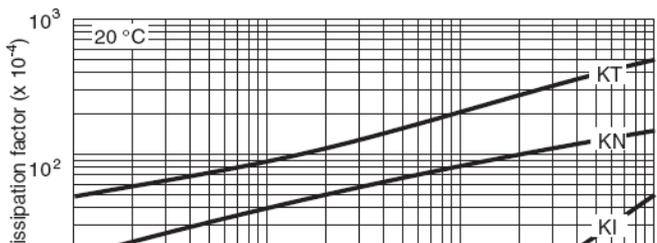
El DF y por lo tanto, la potencia disipada, se incrementa con la frecuencia. Los fabricantes pueden indicar una corriente máxima de rizado.
