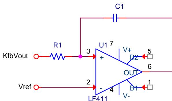
**Fig. 2. posible amplificador de error.** (No se especifican las tensiones de alimentación en la figura, pero se da por hecho que el amplificador estará debidamente polarizado).
