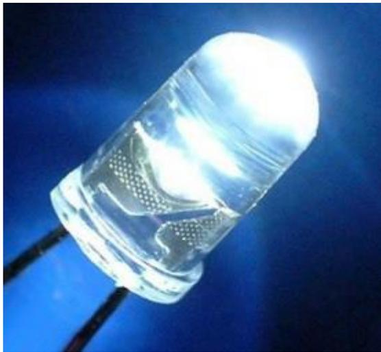
✓ Luz blanca generada por LED's azules o UV con un encapsulado recubierto de sustancia fosforescente ( $Ce^{3+}:YAG$ )
