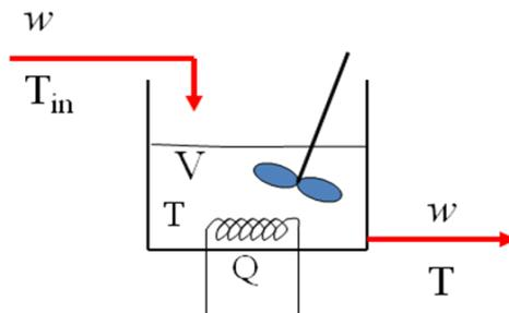
Del balance de energía  $V\rho C \frac{dT}{dt} = wC(T_{in} - T) + Q$
