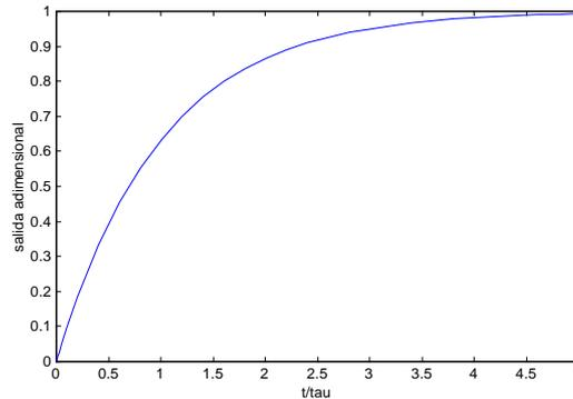
Por ejemplo: consideremos un tanque de  $V = 5\text{m}^3$  con  $v = 1\text{ m}^3/\text{min}$ , concentración en estado estacionario  $1.25\text{ mol/m}^3$ . Considerar un cambio en la concentración de entrada desde  $1.25\text{ mol/m}^3$  a  $1.75\text{ mol/m}^3$ .
