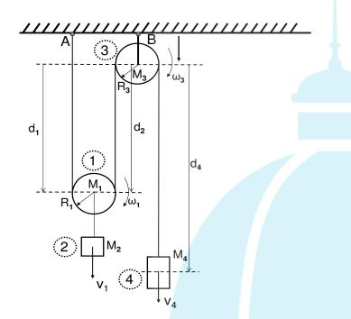
La figura representa un sistema formado por dos poleas, dos masas y una cuerda flexible, inextensible y de masa nula anclada firmemente al techo en el punto A.
