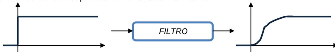
Figura 9. Respuesta de un filtro al escalón unitario
