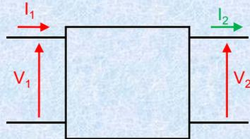
$$\begin{Bmatrix} V_1 \\ I_1 \end{Bmatrix} = \begin{bmatrix} A & B \\ C & D \end{bmatrix} \begin{Bmatrix} V_2 \\ I_2 \end{Bmatrix}$$
