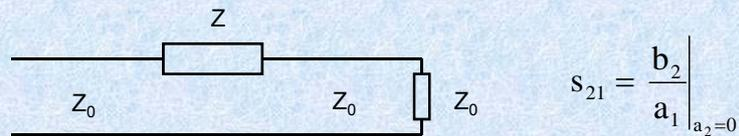
$$I_1^+ + I_1^- = I_2^+ + I_2^- \quad ; \quad \text{siendo} \quad I_2^+ = 0$$
