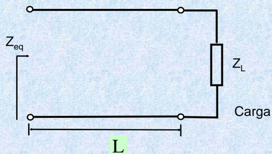
Objetivo: Determinar la impedancia equivalente vista por el generador
