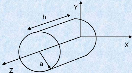
En el interior de la cavidad se pueden generar diferentes ondas estacionarias: diferentes modos
