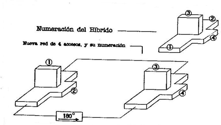
En las Ts mágicas el desfase de 180° se produce entre los accesos 2 y 3 (de acuerdo con la numeración propuesta en la parte superior derecha de la figura). En el desfasador unidireccional anisótropo el puerto de entrada es el de inicio de la flecha. Las longitudes de las líneas que unen cada uno de los circuitos pueden considerarse despreciables. Se pide:
