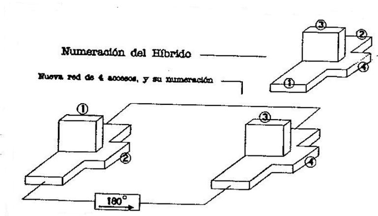
En las Ts mágicas el desfase de  $180^\circ$  se produce entre los accesos 2 y 3 (de acuerdo con la numeración propuesta en la parte superior derecha de la figura). En el desfaseador unidireccional anisótropo el puerto de entrada es el de inicio de la flecha. Las longitudes de las líneas que unen cada uno de los circuitos pueden considerarse despreciables. Se pide:
