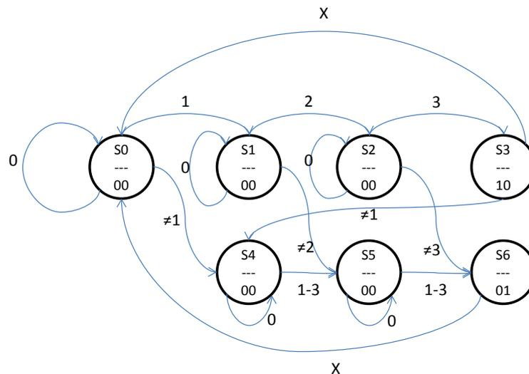
La entrada de teclado se codifica con las variables de entrada  $x_1x_0$ . El estado (salida del contador) viene definido por las variables  $s_2s_1s_0$ . La señal de carga por L, la de contar por C, la entrada paralela de carga por  $i_2i_1i_0$ . La señal de carga (L) tiene preferencia sobre la señal de contar (C). La tabla correspondiente al diagrama de estados es la que sigue:
