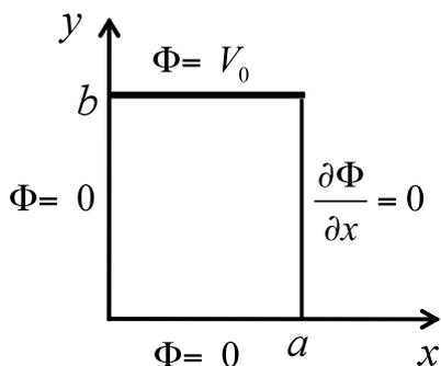
Es un problema electrostático en coordenadas cartesianas. Tenemos que resolver la ecuación de Laplace para unas condiciones de contorno determinadas. Resolvemos por separación de variables. Tendremos:  $\phi(x, y, z) = X(x)Y(y)Z(z)$ . El problema no tiene dependencia en la coordenada  $z$ , así que la solución se reduce a  $\phi(x, y) = X(x)Y(y)$ .
