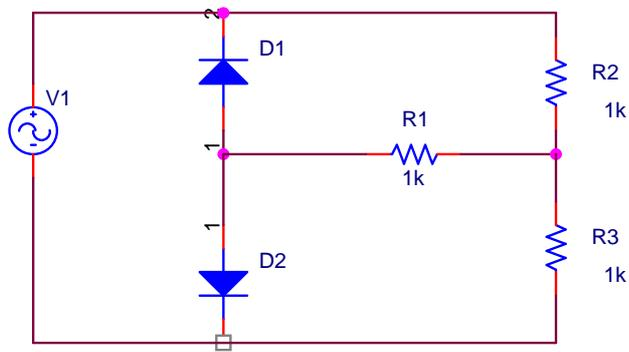
7. Calcular la tensión de salida exacta en el circuito de la figura para un diodo de Ge cuya corriente de saturación es  $I_S = 10 \mu\text{A}$  y cuyo valor aproximado de entrada en conducción es  $V_d = 0.25 \text{ V}$ .
