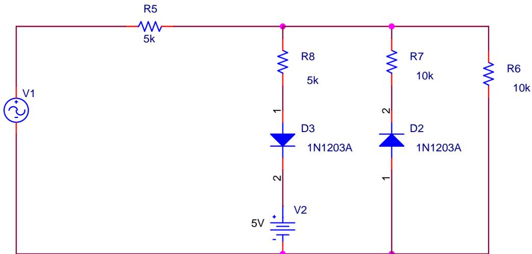
3. Calcular la curva de transferencia en estática y la tensión  $v(R_6)$  en el siguiente circuito. Considerar  $V_t=0.7\text{ v}$
