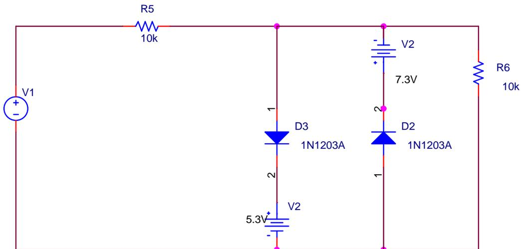
4. Calcular  $R_{L\text{mínima}}$  y  $R_{L\text{máxima}}$  para que  $v(R_L)$  sea igual a  $V_z$  y no se rompa el diodo, considerando que puede disipar 30mW.
