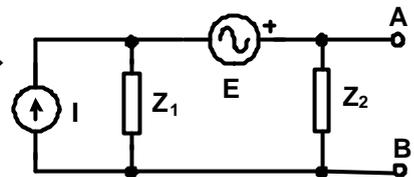
4.10 En el circuito de la figura obtener el equivalente de Norton respecto de A-B.
