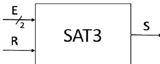
El circuito tiene dos señales de entrada y una de salida:
