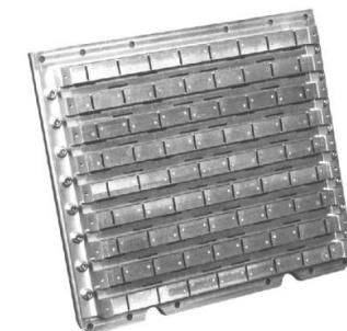
Waveguide slot antenna array
