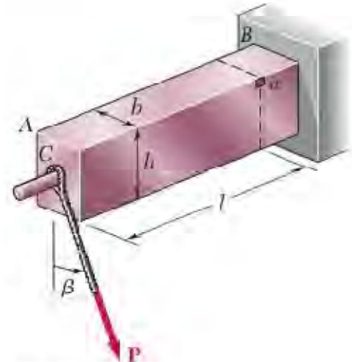
Una fuerza  $\mathbf{P}$  se aplica a una viga en voladizo por medio de un cable unido a un perno ubicado en el centro de su extremo libre. Si se sabe que  $\mathbf{P}$  actúa en una dirección perpendicular al eje longitudinal de la viga, determinar:
