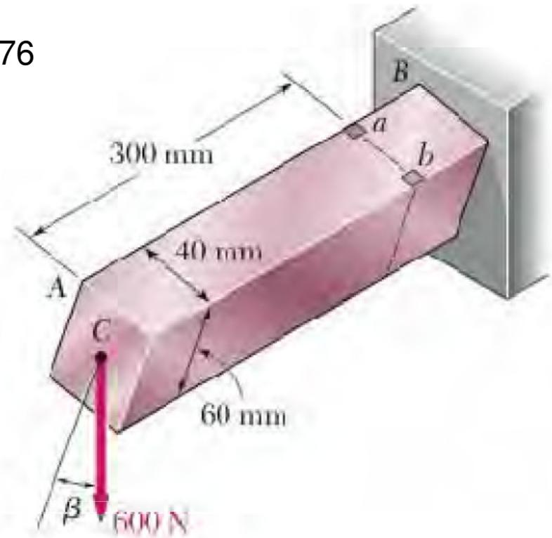
La viga en voladizo  $AB$  se instalará de manera que el lado de  $60\text{ mm}$  forme un ángulo  $\beta$  entre  $0^\circ$  y  $90^\circ$  con la vertical. Si se sabe que la fuerza vertical de  $600\text{ kN}$  se aplica en el centro del extremo libre de la viga, determinar la tensión normal en el punto  $a$  cuando:
