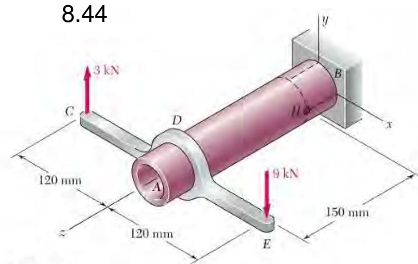
El tubo de acero AB tiene 72 mm de diámetro exterior y 5 mm de espesor de pared. Si se sabe que el brazo CDE está unido rígidamente al tubo, determine los esfuerzos y planos principales, y el esfuerzo cortante máximo en el punto H.
