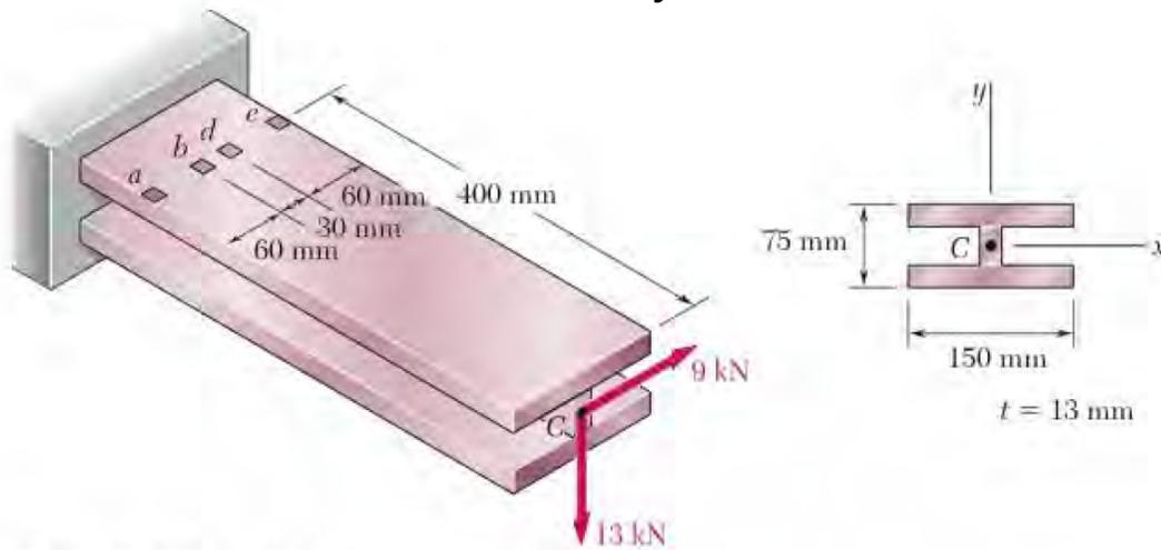
Tras placas, cada una de 13 mm de espesor, se sueldan para formar una viga en voladizo. Para las cargas que se muestran en la figura, determine los esfuerzos normal y cortante en los puntos a, b, c y d.
