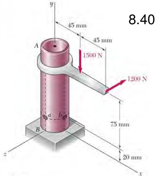
Se aplican dos fuerzas al tubo AB como se muestra en la figura. Si sabe que el tubo tiene un diámetro interior de 35 mm y diámetro exterior de 42 mm, determine los esfuerzos normal y cortante en los puntos a y b.
