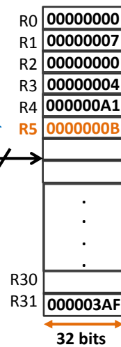
Banco de Registros Después de ejecutar la instrucción
