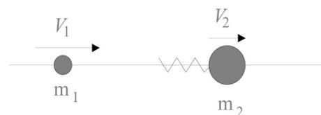
$$m_1 v_1 + m_2 v_2 = (m_1 + m_2) V$$
