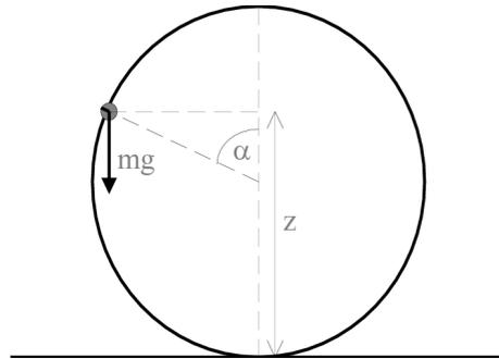
Usando ambas ecuaciones podemos obtener el valor de  $\alpha$  para el que la vagoneta se separa de los raíles si llega al círculo con velocidad  $v_0$ :
