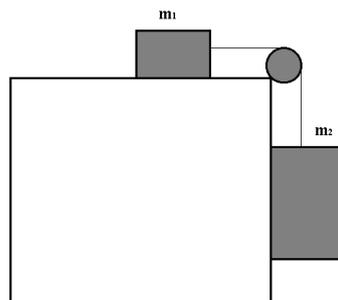
b) Si el sistema esta parado, la tensión de la cuerda tiene que compensar el peso del segundo bloque, por lo que la tensión será:
