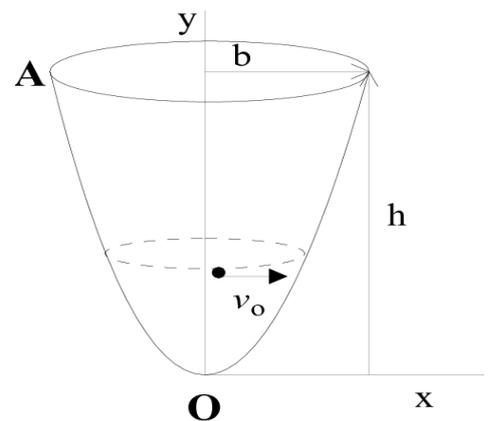
en donde  $C$  es una constante de integración (que es nula ya que la curva pasa por  $x = y = 0$ ). Nótese que la curva obtenida es una parábola. Este resultado nos explica la razón por la cual un líquido que gira uniformemente (que tiene su velocidad proporcional a la distancia al eje de rotación) genera una superficie paraboloidal.
