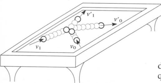
Fig. 20.5 El tercer problema típico de percusiones es el de calcular el nuevo estado cinemático de dos sólidos que chocan.
