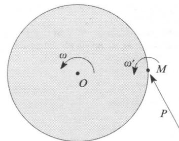
Fig. 20.6 Si un disco gira alrededor de  $O$  y se frena bruscamente en  $M$ , aparece en este punto una percusión  $P$  desconocida.
