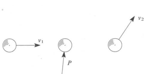
Fig. 20.2 La aplicación de una percusión  $\mathbf{P}$  a una partícula se manifiesta en un cambio brusco de su velocidad.
