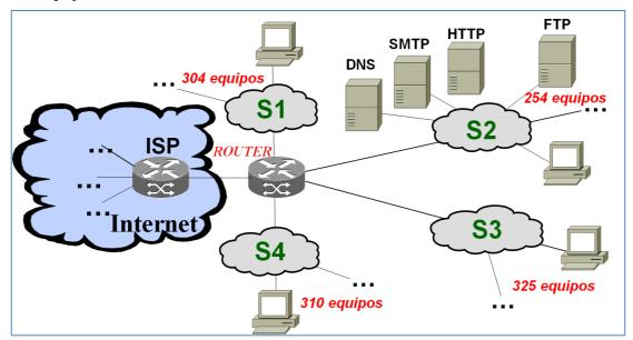
En la anterior figura se muestra el escenario planteado en dicha organización y en donde el router de entrada y salida (ROUTER) de la organización se conecta vía Ethernet con el router de su ISP u operador.
