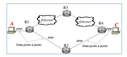
Una organización dispone de dos sistemas finales "A" y "C" que se encuentran conectados a los routers R1 y R4, respectivamente, mediante una línea serie o punto a punto que dispone del protocolo PPP como protocolo del interfaz de la red de acceso. Ídem, entre R1-R2 y R2-R4. A su vez, los routers R1-R3-R4 se conectan mediante redes Ethernet.
