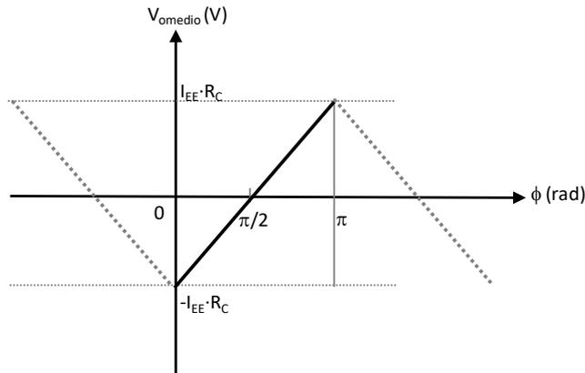
$$V_{\text{omedio}} = 0 \text{ cuando } \Delta\phi = \pi/2$$
