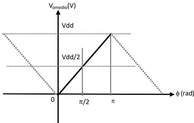
$$V_{\text{omedio}} = V_{\text{dd}}/2 \text{ cuando } \Delta\phi = \pi/2$$
