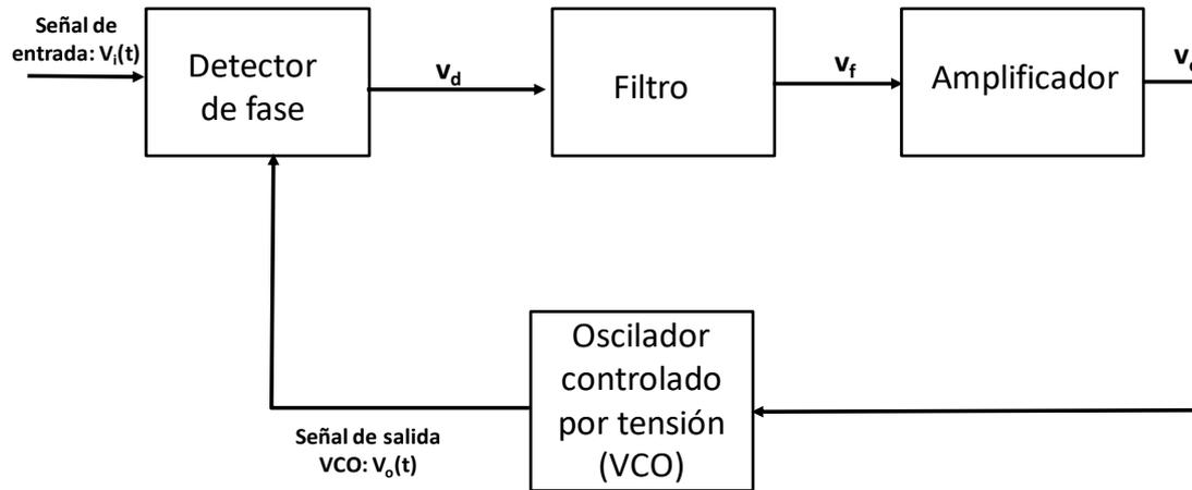
Hasta ahora,  $v_i(t)$  y  $v_o(t)$  se han tratado como ondas sinusoidales, pero pueden ser ondas cuadradas dependiendo del tipo de aplicación.
