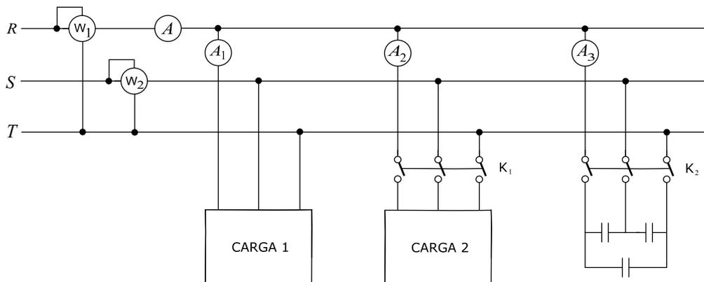
Cuando los interruptores  $K_1$  y  $K_2$  están abiertos, las indicaciones de los vatímetros son  $W_1 = 4 \text{ kW}$ ;  $W_2 = 0$ . Se pide:
