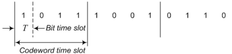
Desde el punto de vista físico los bits se implementan mediante pulsos eléctricos de duración  $T'$  (que codifican los 1) y ausencia de pulsos (que codifican los 0). El tiempo reservado para la transmisión de un bit es  $T$ .
