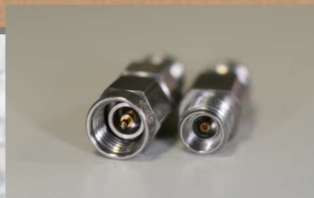
TIPO 3,5 mm: Macho y Hembra F_{max} : 26,5 \text{ GHz}
