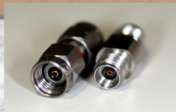
TIPO 2,92 mm: Macho y Hembra F_{max}: 40 \text{ GHz}
