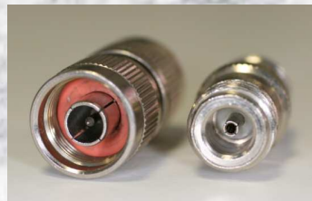
TIPO N: Macho y Hembra F_{max}: 18 \text{ GHz}
