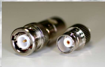
TIPO BNC: Macho y Hembra F_{max} : 4 \text{ GHz}
