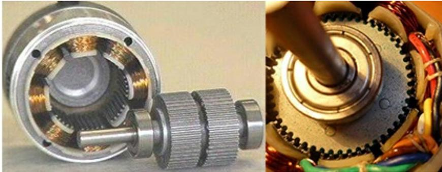
Estator y rotor de un motor paso a paso. Fuente: Wikimedia Commons, (2015)
