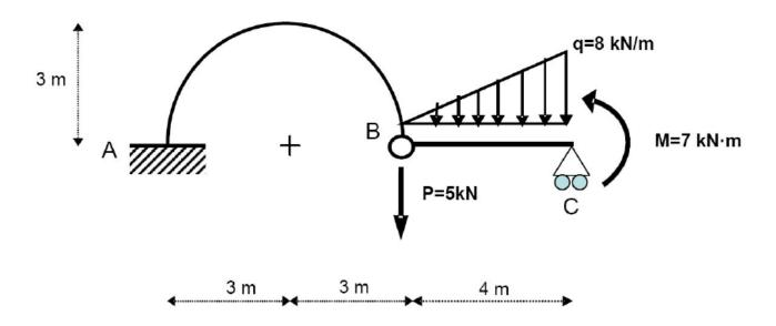
**PROBLEMA 15:** Determine los diagramas de esfuerzo cortante y momento flector de la siguiente estructura. Dibuje dichos diagramas, acotando sus valores característicos.
