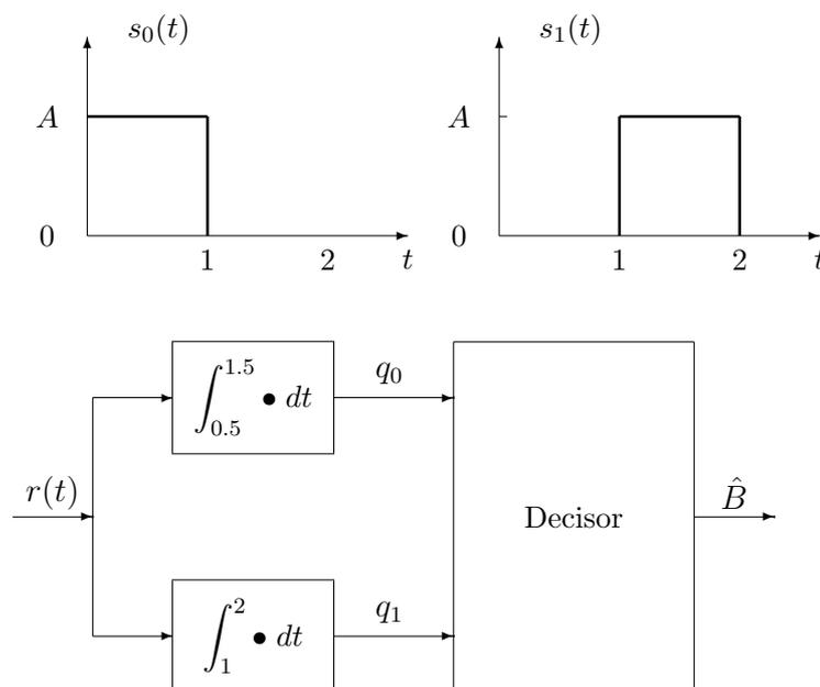
Figura 3.53: Señales y receptor del Problema 3.22.
