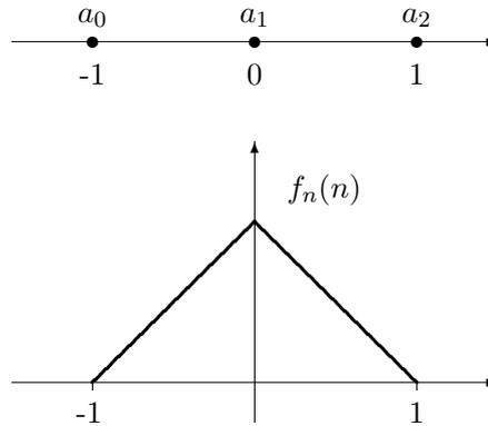
Figura 3.56: Constelación y función densidad de probabilidad del término de ruido para el Problema 3.25.
