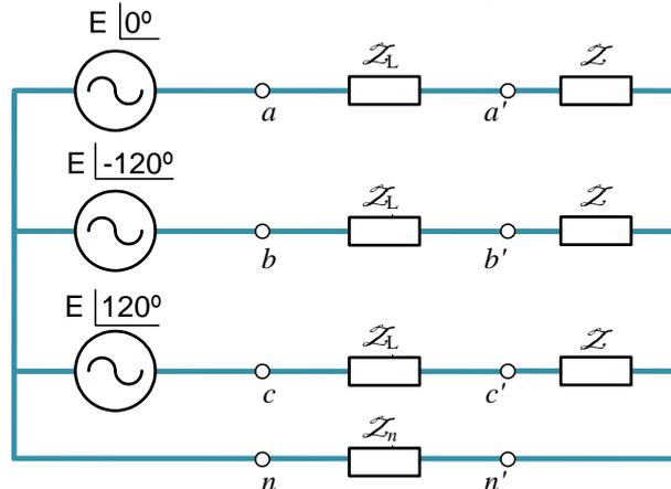
a) *Obtener el circuito monofásico equivalente.*
