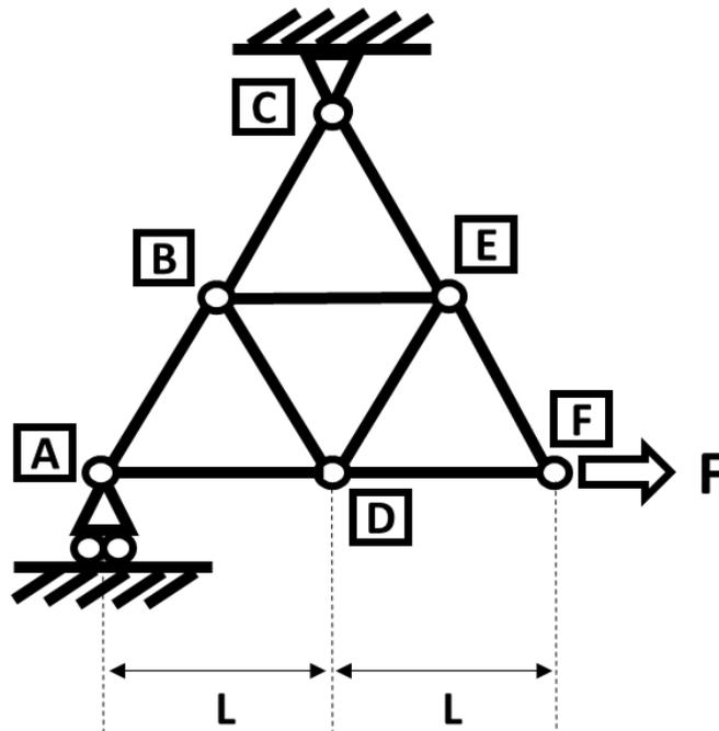
Se pide calcular el desplazamiento horizontal del nudo F (2.5 puntos).
