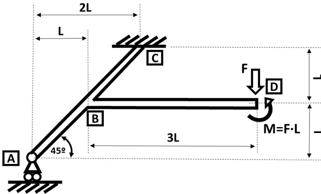
Se pide, resolviendo por el **método de la FLEXIBILIDAD**, la reacción que soporta el apoyo A.
