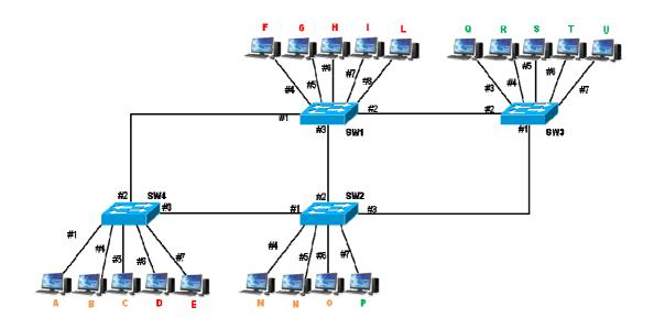
7. Sea la topología de una red de área local como la representada en la figura. Las direcciones MAC de los conmutadores Sxx son 00-00-00-AA-AA-xx. La prioridad de cada puente se configura al valor por defecto. Todos los enlaces tienen un coste STP igual a 19.
