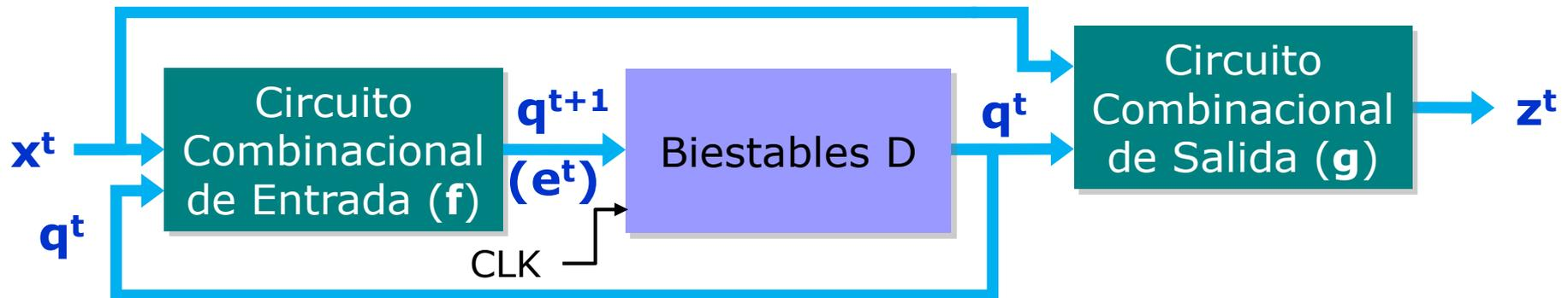
Función de salida (**g**)  $z^t = \mathbf{g} [x^t, q^t]$  Función de transición (**f**)  $q^{t+1} = \mathbf{f} [x^t, q^t]$
