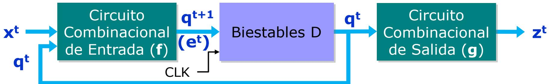
Función de salida (**g**)  $z^t = \mathbf{g} [q^t]$  Función de transición (**f**)  $q^{t+1} = \mathbf{f} [x^t, q^t]$
