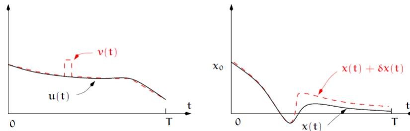
La entrada  $u(t)$  genera la trayectoria  $x(t)$ . Una variación  $v(t)$  en  $u(t)$  genera una trayectoria diferente  $x(t) + \delta x(t)$
