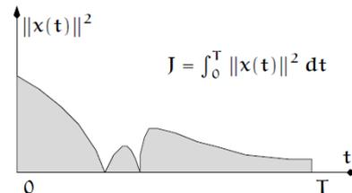
De la misma manera, si se actúa sobre el área de la curva de módulos cuadráticos correspondientes a la entrada, estaríamos seleccionando aquellos controles que requieren menos esfuerzo de actuación.
