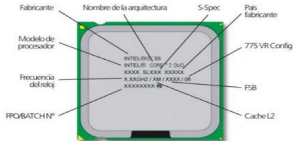
↑ Interpretación de la información de un microprocesador Intel Core 2 Duo®.
