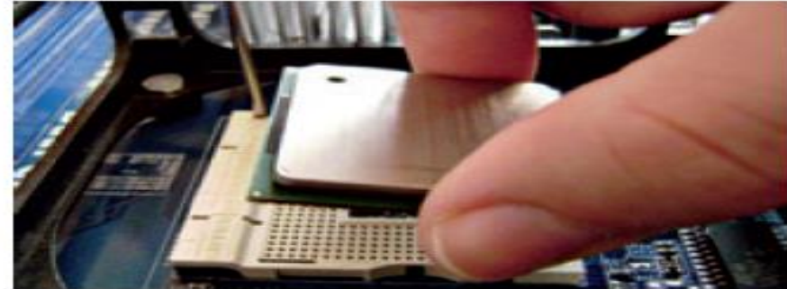
↑ Orientación y colocación del microprocesador (3 y 4).
