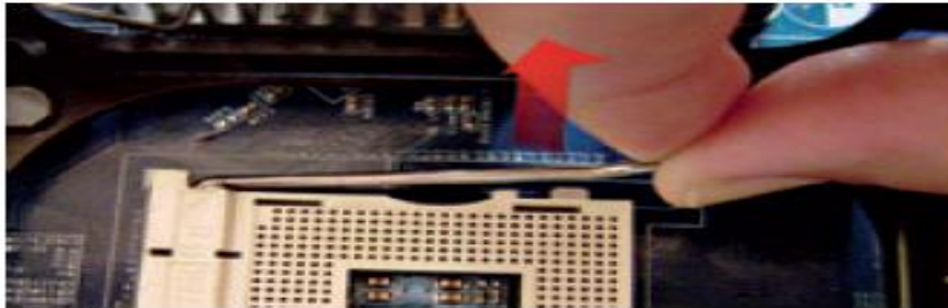
↑ Movimiento de apertura del socket (derecha y arriba) (1 y 2).
