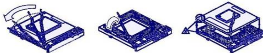
Pasos para el montaje de un procesador con encapsulado LGA en un Socket
