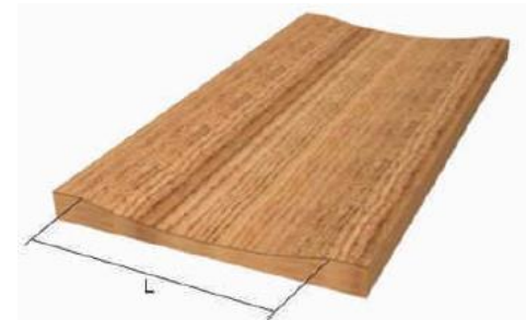
Falta de material por cepillado
