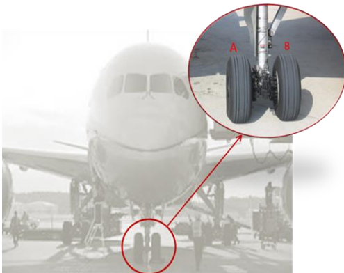
Figura 1. Vista frontal del tren de aterrizaje delantero
