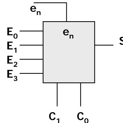
La entrada de datos correspondiente al número codificado en binario en las señales de control se conecta a la salida
