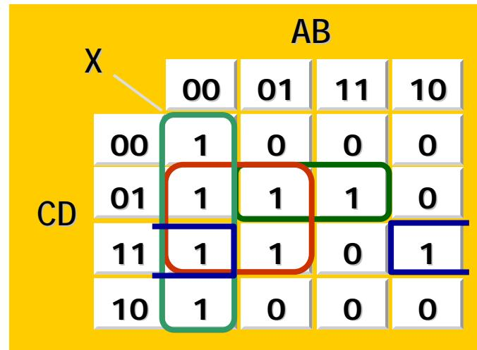
$$Y = \overline{A} \cdot \overline{B} + \overline{A} \cdot D + B \cdot \overline{C} \cdot D + \overline{B} \cdot C \cdot D$$
