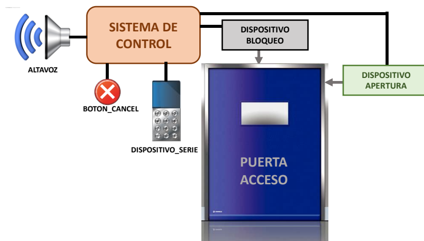
Figura 1. Esquema del sistema de acceso con cerradura electrónica
