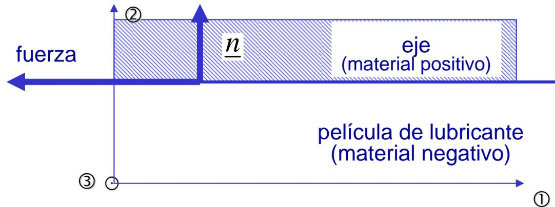
Puesto que toda la superficie exterior del eje está sometida a este mismo esfuerzo cortante, y la fuerza de resistencia viscosa es perpendicular al radio del eje, el par resistente total es:
