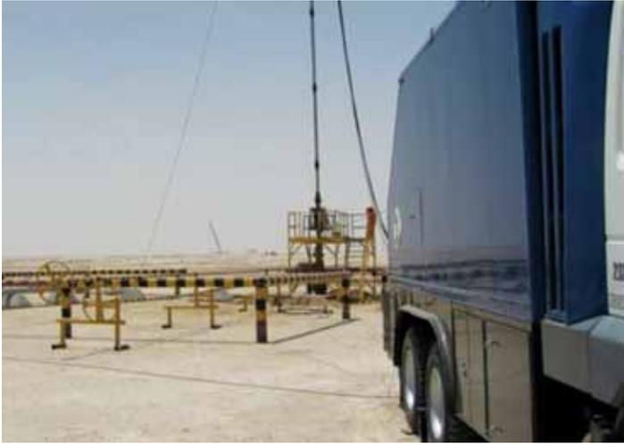
^ Prospección entre pozos remotos en Medio Oriente. Un arreglo de receptores queda suspendido por encima de un cabezal de pozo (*centro*) antes de ser bajado en un pozo. En el horizonte, una sarta de herramientas cuelga suspendida en el pozo por debajo de un cabria inclinada.
