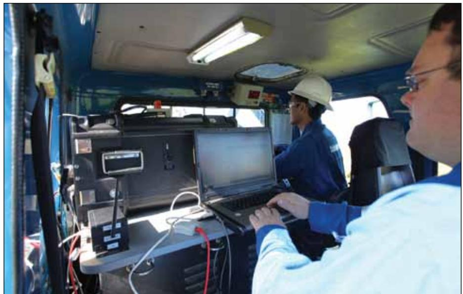
^ Interior de la unidad de adquisición de registros. La operación de adquisición de registros es controlada habitualmente desde un ordenador portátil (*laptop*) situado en el pozo transmisor, donde los comandos y los datos se intercambian en forma inalámbrica entre el pozo transmisor y el pozo receptor.
