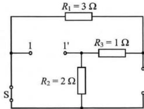
Por último, hay que determinar la constante de tiempo del circuito. Para ello, se anulan las fuentes independientes y se determina la resistencia de entrada del dipolo conectado a la bobina. Se muestra este dipolo en la figura SP 14.1d, del que se deduce, por simple inspección,
