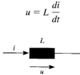
Figura 1.5. Bobina con referencia de potencia entrante.
