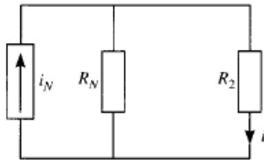
De esta forma se tiene un divisor de corriente, y la corriente que circula por la resistencia  $R_2$  es:
