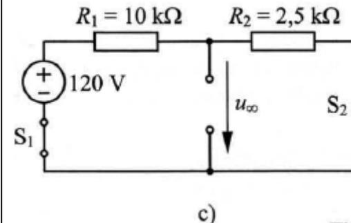
$$u_\infty(t') = \frac{R_2}{R_1 + R_2} U_s = \frac{2,5 \cdot 10^3}{10 \cdot 10^3 + 2,5 \cdot 10^3} 120 = 24 \text{ V}$$
