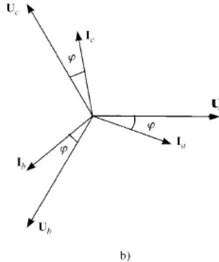
Si conectan en triángulo tres impedancias iguales  $Z_\Delta$  tales que formen un sistema en triángulo equivalente al previo en estrella ( $Z_\Delta = 3 \cdot Z_Y$ ), las corrientes que circularán por cada una de las impedancias serán:
