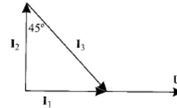
Las otras dos corrientes vienen dadas, puesto que los desfases relativos están impuestos por las impedancias ( $I_2$  debe estar adelantada  $90^\circ$  respecto a la tensión, e  $I_3$  retrasada  $45^\circ$  respecto a la misma tensión) y el hecho de que  $I_2 + I_3 = I_1$ . Esto permite deducir los valores de las corrientes.
