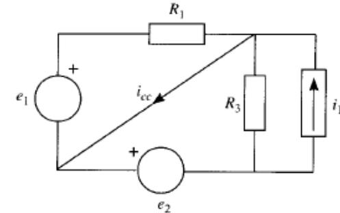
La fuente de corriente ideal en paralelo con la resistencia  $R_3$  se puede transformar a una fuente de tensión ideal en serie con una resistencia:
