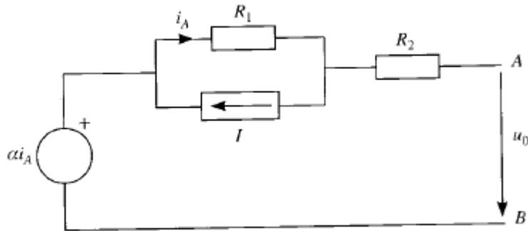
Por la resistencia  $R_2$  no circula corriente al estar abierto el circuito y, por tanto,
