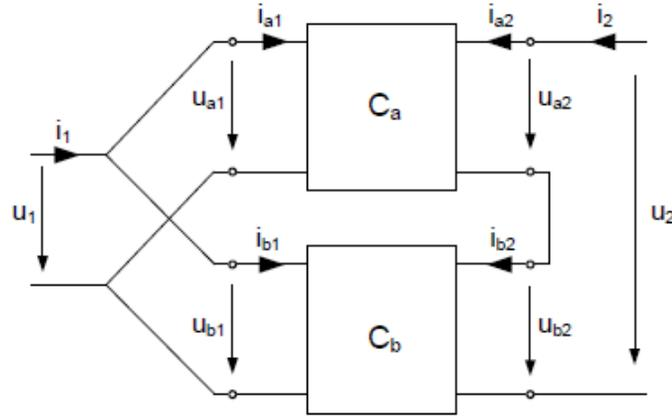
$$\begin{pmatrix} i_1 \\ u_2 \end{pmatrix} = [K_a] \cdot \begin{pmatrix} u_{a1} \\ i_{a2} \end{pmatrix} + [K_b] \cdot \begin{pmatrix} u_{b1} \\ i_{b2} \end{pmatrix} = ([K_a] + [K_b]) \cdot \begin{pmatrix} u_1 \\ i_2 \end{pmatrix}$$
