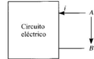
Figura 1.2. Dipolo con referencias de potencia entrante.
