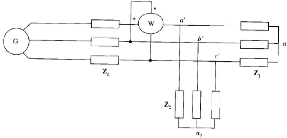
La medida del vatímetro sería proporcional a la potencia reactiva consumida por las dos cargas:
