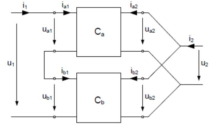
$$\begin{pmatrix} i_{a1} \\ u_{a2} \end{pmatrix} = \begin{pmatrix} i_{b1} \\ u_{b2} \end{pmatrix} = \begin{pmatrix} i_1 \\ u_2 \end{pmatrix}$$
