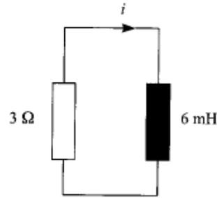
que tiene una constante de tiempo  $\tau_1 = 6 \cdot 10^{-3} / 3 = 2\ \text{ms}$ . Adviértase que la resistencia de  $4\ \Omega$  no interviene en este circuito (ni en el del condensador, claro está) puesto que por ella no circula ninguna corriente.
