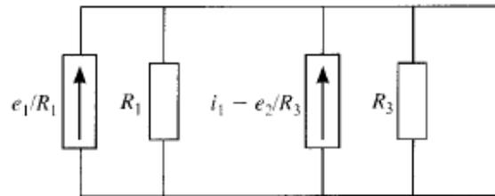
Agrupando las fuentes de corriente por un lado y las resistencias por otro, se obtiene el equivalente Norton buscado:
