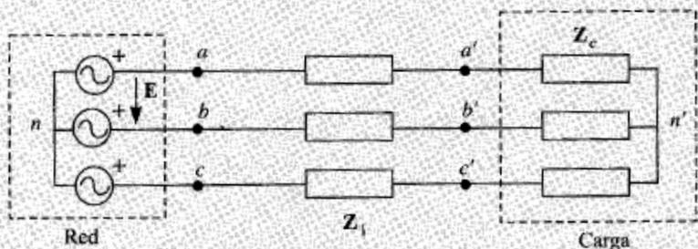
Cuando la tensión aplicada a la carga es de 400 V, consume una potencia activa  $P = 12,8$  kW y una potencia reactiva  $Q = 9,6$  kVAr.
