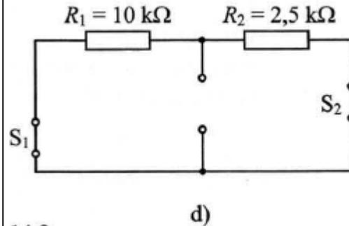
Para determinar la constante de tiempo se anulan las fuentes independientes del dipolo conectado al condensador, con lo que se obtiene el circuito dado en la figura SP 14.2d. La resistencia de entrada de este dipolo es
