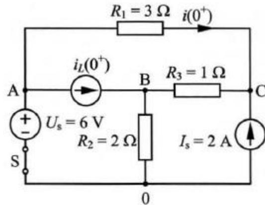
Para hallar  $i(0^+)$  hay que determinar primero  $i_L(0^-)$ . En  $t = 0^-$  el circuito está en un régimen permanente de continua por lo que, de nuevo, la bobina se trata como un cortocircuito. Además el interruptor está abierto, por lo que la rama donde está la fuente de tensión se puede sustituir por un circuito abierto. Queda el circuito de la figura SP 14.1b, en el que al aplicar el concepto de divisores de intensidad se tiene
