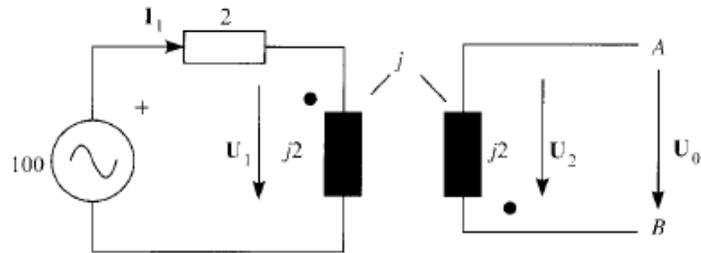
En este circuito se cumple que  $U_0 = U_2$ . Además, según las ecuaciones de las bobinas acopladas:
