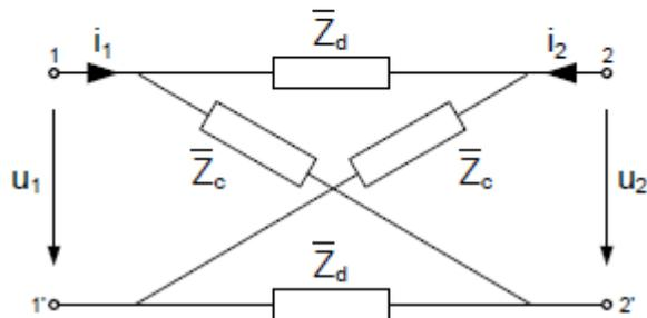
Como un cuadripolo simétrico y, por tanto, recíproco queda definido por dos de sus parámetros y como el cuadripolo en X simétrico contiene sólo dos elementos distintos, se deduce que, en general, cualquier cuadripolo simétrico puede representarse por un cuadripolo en X simétrico.
