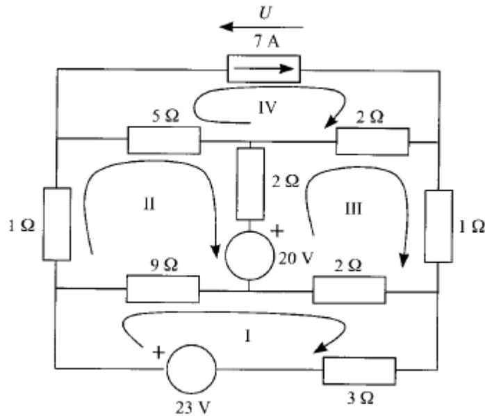
Pero la fuente de corriente impone la intensidad  $i_{IV} = 7 \text{ A}$ . Por tanto, el sistema de ecuaciones queda como se indica a continuación:
