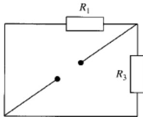
Para hallar la resistencia Norton se anulan las fuentes de tensión y de corriente, siendo el circuito resultante el que se muestra en la figura. La resistencia equivalente es el paralelo entre  $R_1$  y  $R_3$ :
