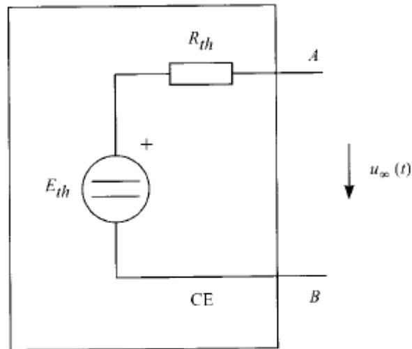
En este caso, la tensión en régimen permanente en el condensador coincide con el valor de la fuente del equivalente Thévenin, es decir,  $u_{\infty} = u_{\infty}(0) = 10$  V. Por tanto, la tensión en el condensador será:
