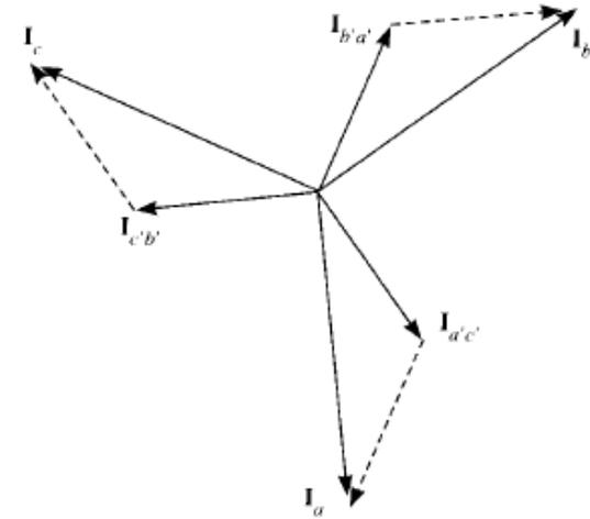
En él, el origen de fases sigue estando en  $E_{ca}$ . Las corrientes de fase por los triángulos están adelantadas  $30^\circ$  con respecto a las corrientes de línea, y tienen una magnitud  $\sqrt{3}$  veces menor. Por tanto:
