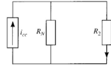
Como comprobación se calcula la tensión a circuito abierto. Para ello se toma el circuito equivalente mostrado a continuación:
